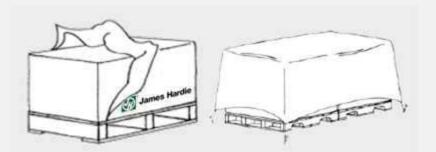
L'humidité expose les lames à des altérations irréversibles, notamment à l'apparition d'efflorescences.
