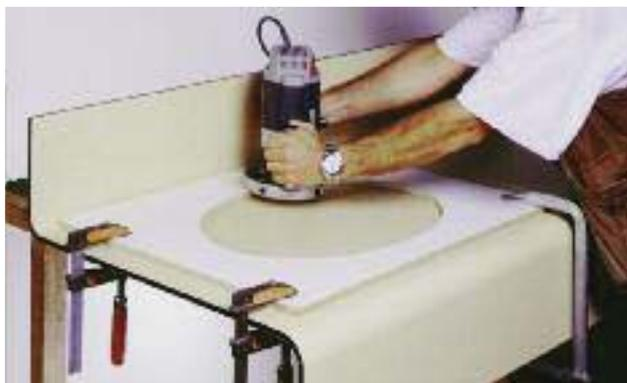
1. Tracé de l'évidement et fraisage à la défonceuse
