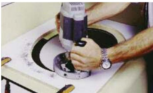
2. Fraisage d'une feuillure sur la face inférieure de l'élément FunderMax Compactforming avec une fraise droite ou sur un centre d'usinage CNC
