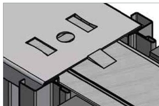
Nouveau guide au sol intégré dans le caisson (autocentrage).
