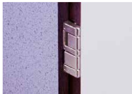
CHARNIERE (STE PRAMATA) POUR PORTE EN PANNEAU COMPACT INTERIOR, EPAISSEUR DE LA PORTE 10-13 MM. ROTATION SUR UN SEUL AXE.
