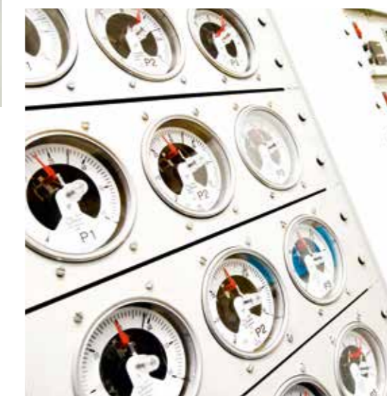
Dans le laboratoire d'essais pour les systèmes de canalisation, les points sont mesurés et suivis sur la courbe de temps avant rupture standard. Par exemple, la durée de vie d'un échantillon de tube à 90°C et 10 bar est quantifiée et enregistrée.
