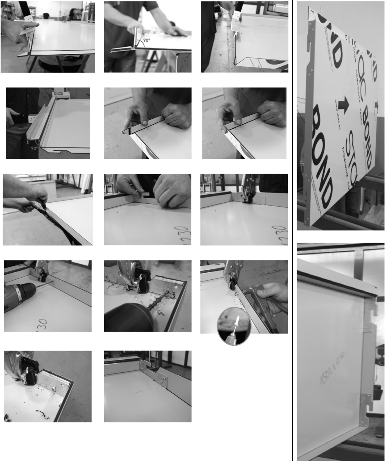
Figure 2b – Façonnage des cassettes (Usinage/Assemblage)
