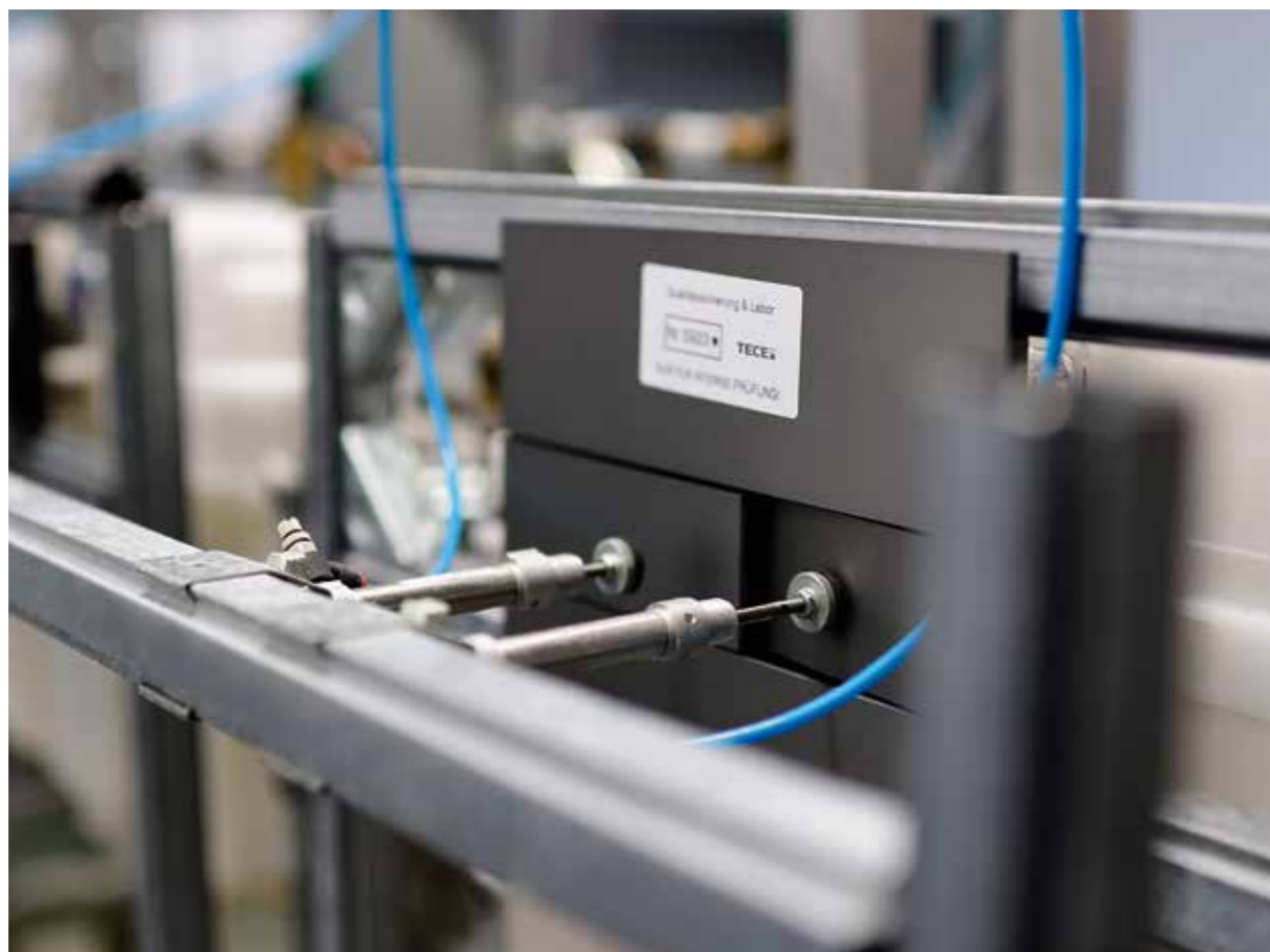
Le mécanisme d'actionnement des plaques de déclenchement est soumis à un essai de fatigue de 200 000 cycles et doit être parfaitement opérationnel par la suite.
