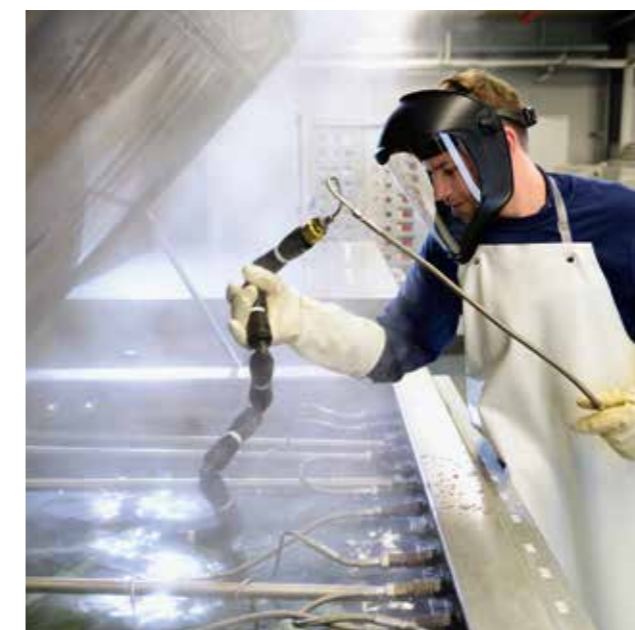
Un « arbre d'essai » avec différents points de raccordement fait l'objet d'essais de fuites dans un bain d'eau à 90°C et à 10 bar. Toutes les fuites sur les composants défectueux peuvent être rapidement identifiées. Toutes les pièces produites sont dispensées d'autres contrôles grâce au système de suivi par lots.
