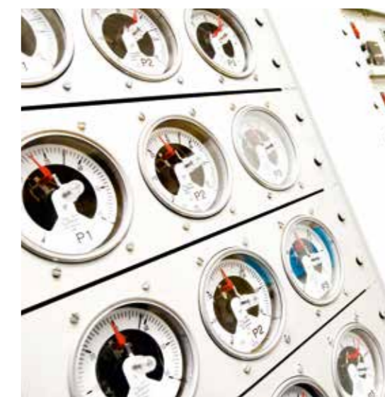
Dans le laboratoire d'essais pour les systèmes de canalisation, les points sont mesurés et suivis sur la courbe de temps avant rupture standard. Par exemple, la durée de vie d'un échantillon de tube à 90°C et 10 bar est quantifiée et enregistrée.
