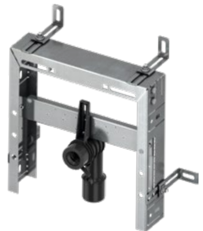
Module de lavabo TECEbox, hauteur d'installation 8 cm : À monter devant un mur porteur. Avec qu murales en profondeur réglables. Profondeur d'installation 8-19 cm. Distance de fixation céramique 17-28 cm.
