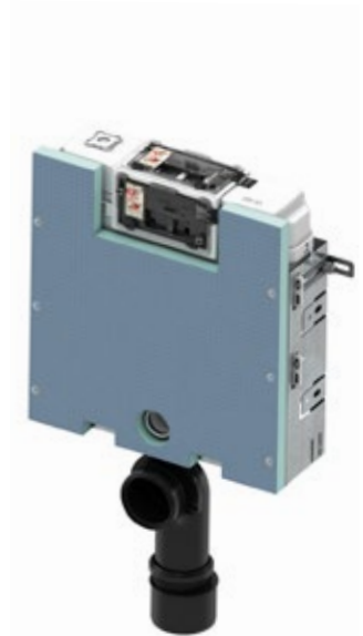
Module WC TECEbox avec réservoir Uni et base carrelée avant, hauteur d'installation 820 mm : Module WC pour le montage dans une cloison maçonnée devant un mur porteur, à profondeur réglable.
