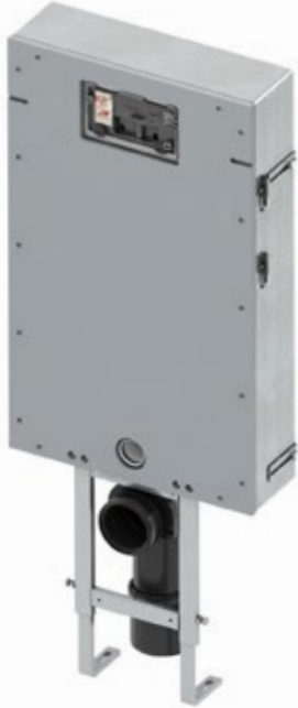
Module WC TECEbox avec réservoir Uni, avec plaque avant à carreler, hauteur d'installation 1110 mm : Module de toilettes pour installation dans une cloison maçonnée. Surface fermée, adaptée au carrelage, en plaques de béton léger en fibre de verre. Pieds de support réglables en hauteur inclus.
