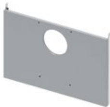
Recouvrement d'espace de montage TECEbox : Tôle d'acier avec panneau de béton léger en fibres de verre vissé. Faire face à toute la surface de construction inférieur de la TECEbox avec une surface à carreler.
