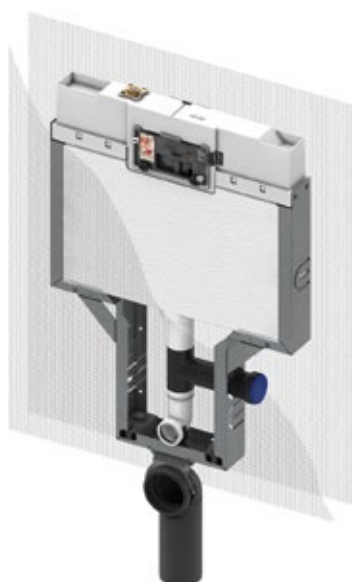
Module WC TECEbox avec réservoir Uni, 8 cm, avec raccordement pour extraction d'odeurs, hauteur d'installation 1110 mm.
