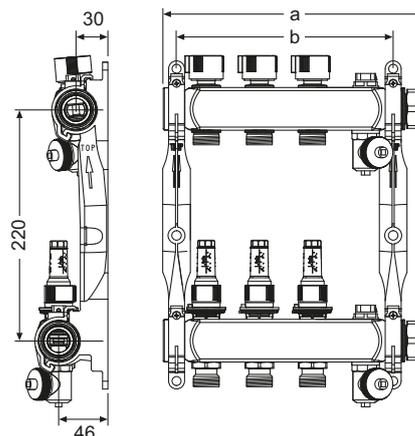
**Set d'extension TECEfloor pour collecteur chauffage avec débitmètre**
